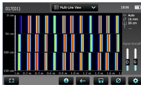
Рисунок 25: Режим просмотра многополосного сканирования с цветовым спектром силы сигнала
