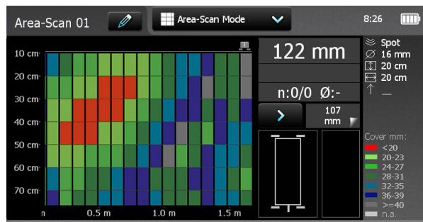
Защитный слой показан только до 90 % от диапазона защитного слоя, показанного на Рисунок 3
