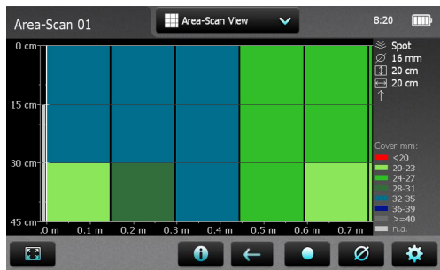
Рисунок 27: Просмотр зонального сканирования (приближен для отображения осей X и Y с одинаковым масштабом)
