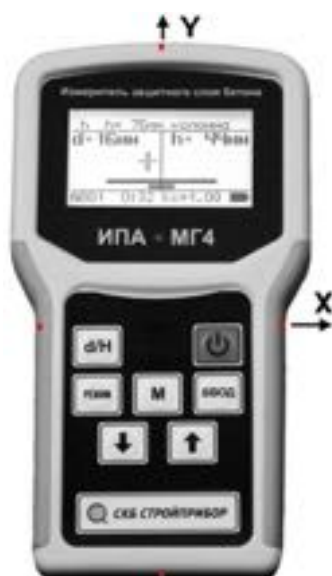
Рисунок 1- Общий вид измерителя ИПА-МГ4.02
