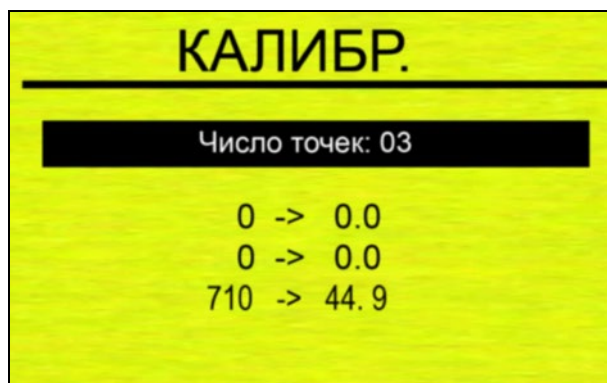
Рис 4.9 Окно прибора после калибровки 1-й точки
