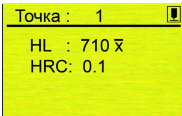
Рис 4.7 Окно прибора после проведения усреднения измеренных значений
