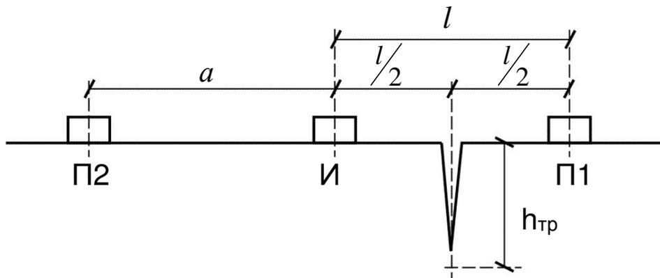
где  $l$  – база измерения на бетоне через трещину (положение датчиков И-П1), трещина расположена ровно по середине, при этом время распространения продольной волны –  $t_1$ ;
