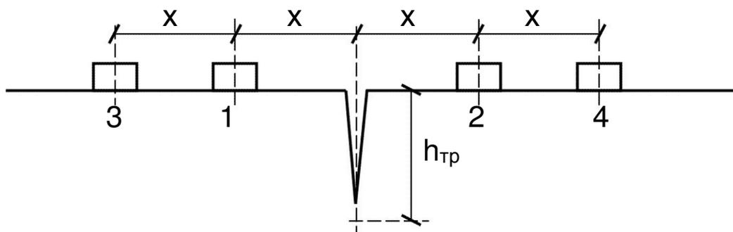
Сначала датчики устанавливаются на точки 1-2 схемы (трещина находится посередине, т.е.  $l=2x$ ) и измеряется время  $t_1$ , затем датчики устанавливаются на точки 3-4 (трещина – посередине  $l=4x$ ), измеряется время  $t_2$  и при нажатии клавиши **М** автоматически вычисляется глубина трещины по формуле:
