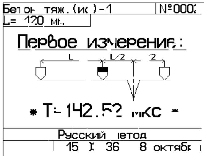
Затем нажать клавишу **М** (для фиксации первого этапа измерения), переместить датчики согласно новой схеме и выполнить второе измерение. После очередного нажатия клавиши **М** на дисплее выводится время первого и второго измерения в мкс и рассчитанное значение глубины трещины.
