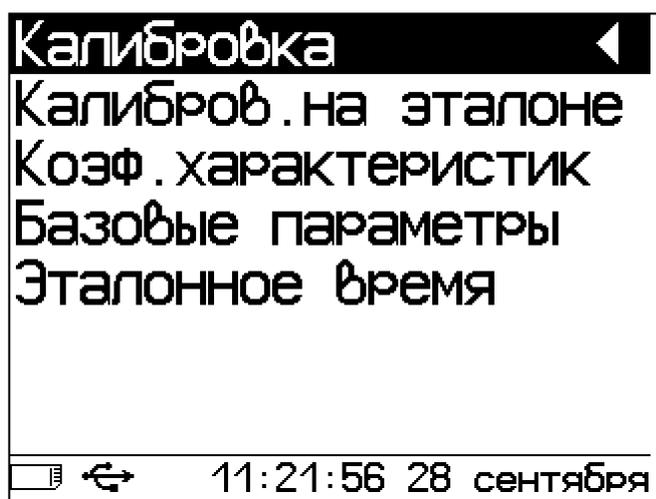
4.5.4.1 Пункт "Калибров. на эталоне" служит для проверки работоспособности прибора и компенсации аппаратных задержек в измерительном тракте прибора. При сквозном и поверхностном прозвучивании калибровка осуществляется на контрольном образце. Калибровку запускают нажатием клавиши **(C)**, после ее завершения индицируется время аппаратной задержки  $\Delta t$ . Для запоминания результата калибровки и выхода в главное меню следует нажать клавишу **(F)**.
