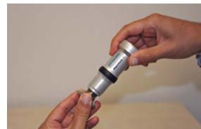
Рисунок 17: Equotip Portable Rockwell с трехточечным опорным кольцом
